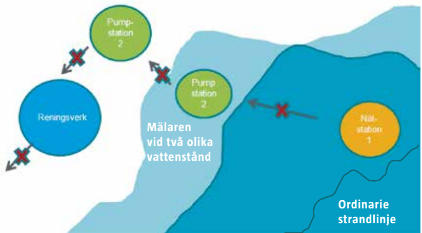
Figur 8. Figuren visar ett verkligt exempel från Mälarenregionen där en liten tuva välter stora lass. Ett reningsverk som ligger högre än +3,1 meter kommer att stå utan el till en huvudpump till följd av att en nätstation i en längre beroendekedja slås ut redan vid en vattennivå på +1,5 meter. De överkryssade pilarna visar att det inte finns någon service (el respektive pumpning) mellan beroende objekt.
