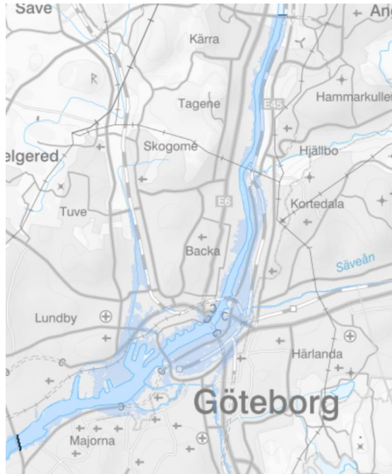
Figur 8. Karta över geografisk avgränsning för hotkarta havet inre. (200-årsnivå i slutet av seklet) För bättre upplösning se: Översvänningsportalen (msb.se)
